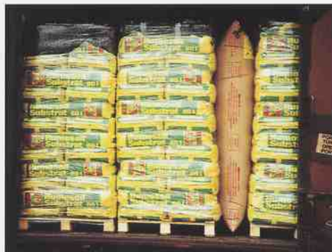
Les coussins de calage ITW Shippers calent efficacement les marchandises les plus lourdes dans les transports ferroviaires en résistant parfaitement aux tamponnages dans les gares de triage.
