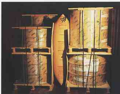
Les coussins ITW Shippers sont utilisés pour protéger des lourdes bobines de papier de tout dégât pendant leur transport d'un bout à l'autre de la planète.
