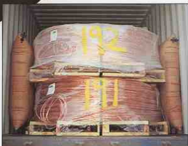
Des palettes de fils de cuivre de plusieurs tonnes sont calées dans les conteneurs grâce aux coussins ITW Shippers qui amortissent les chocs pendant le transport.
